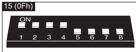
Рис. 20. Способ установки адреса в модуле расширения выходов.
